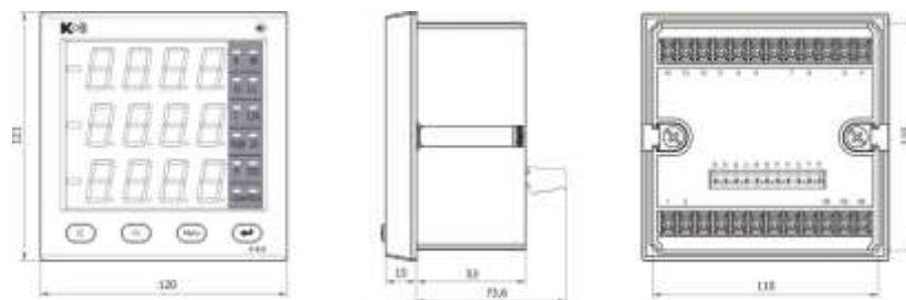
Рисунок 3.5 – Внешний вид и размеры прибора PD194PQ-2K4T-11001
