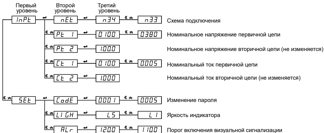
Рисунок 4.30 – Структура меню программирования ваттметров (варметров) модификаций PS194P(Q)-□X1□-0000□
