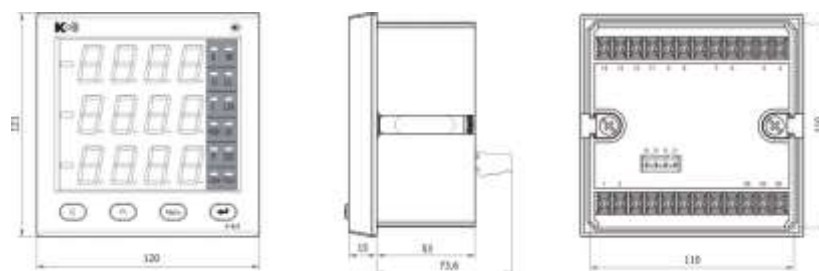
Рисунок 3.4 – Внешний вид и размеры прибора PD194PQ-2K4T-00301
