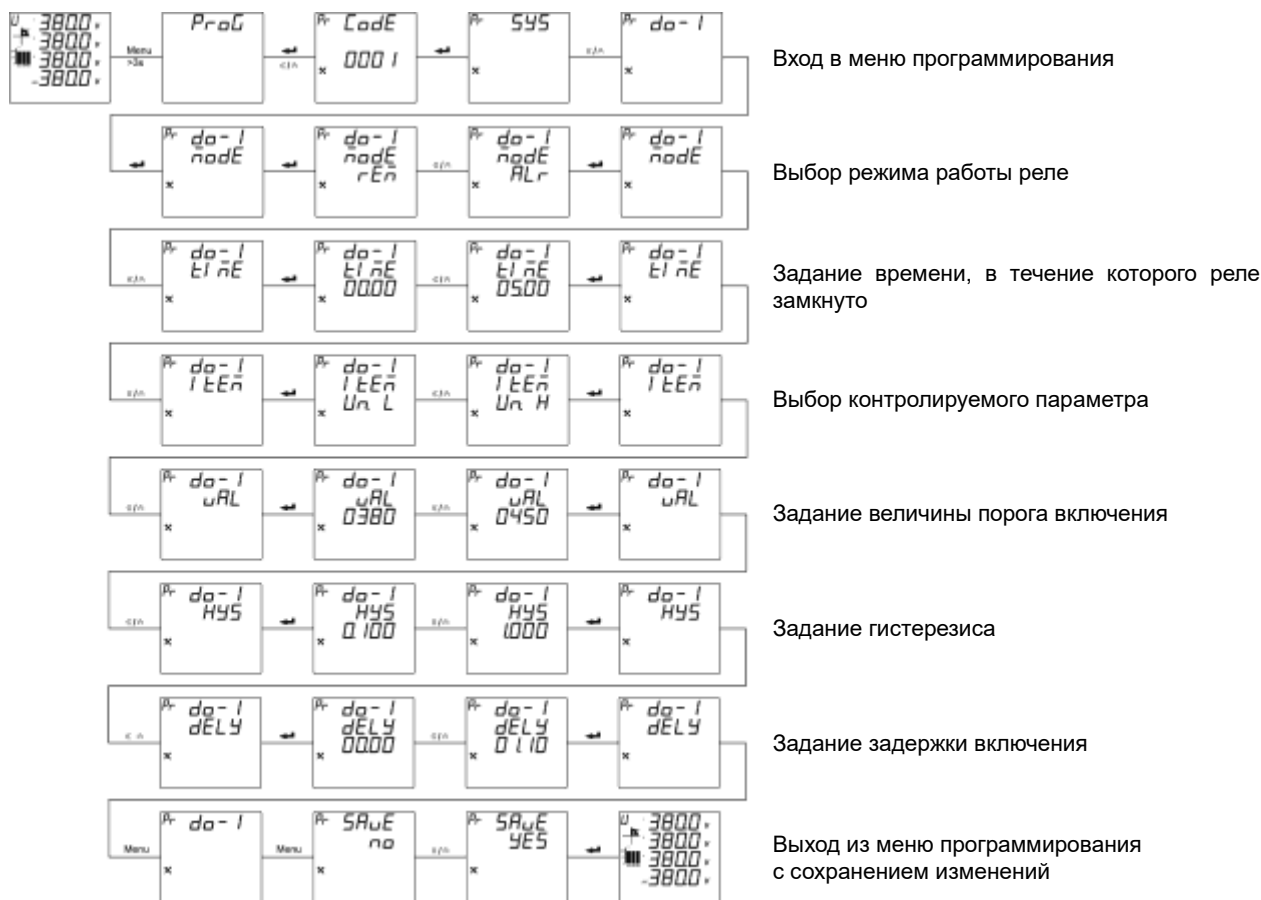
Рисунок 4.60 – Настройка релейного выхода прибора PD194E с ЖК-индикатором (модификация PD194E-9□3□)
