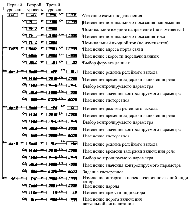
Рисунок 4.26 – Структура меню программирования 3-фазных приборов модификаций PA194(5)I-K4(3)-1100, PZ194(5)U-K4(3)-1100, PD194UI-K4-1100
