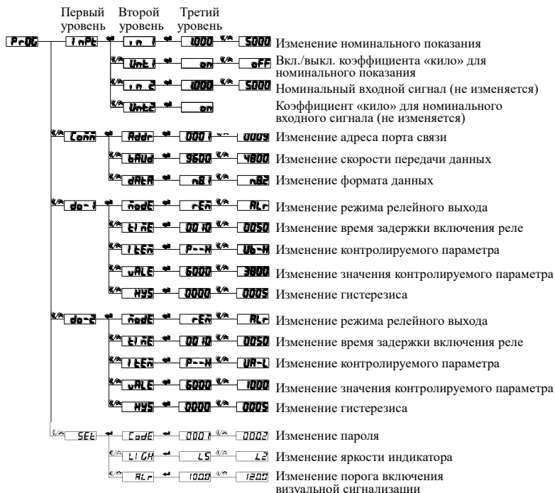
Рисунок 4.24 – Структура меню программирования 1-канальных приборов PA194(5)I-K1-1100, PZ194(5)U-K1-1100
