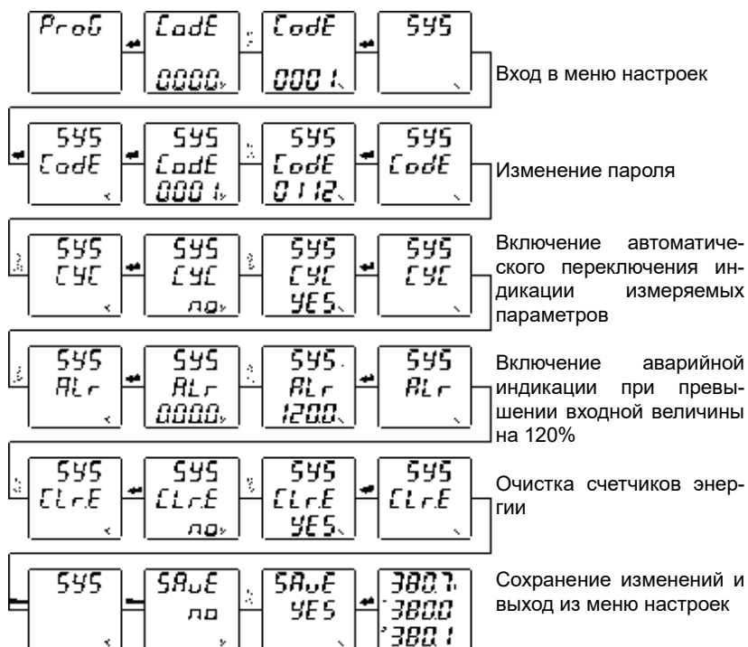
Рисунок 4.62 – Настройка системных параметров прибора PD194E с ЖК-индикатором (модификация PD194E-8□3□)
