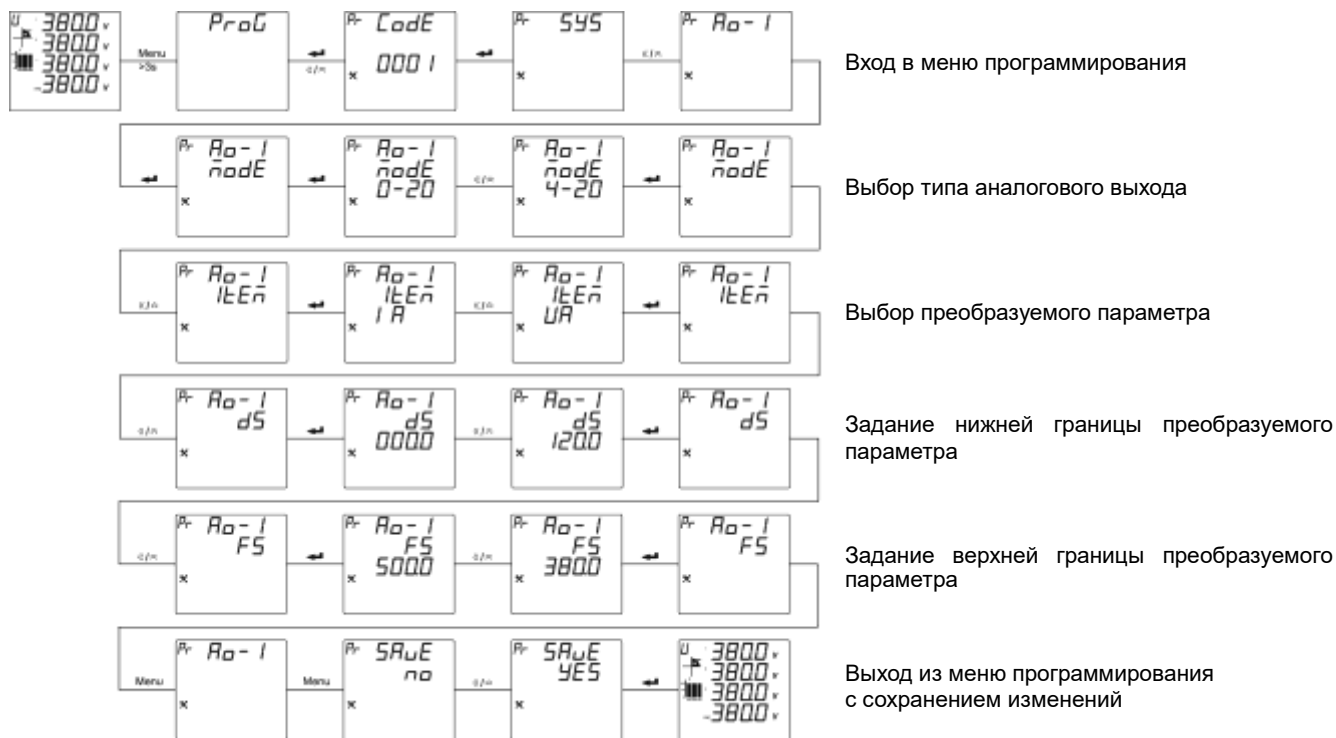
Рисунок 4.61 – Настройка аналогового выхода прибора PD194E с ЖК-индикатором (модификация PD194E-9□3□)
